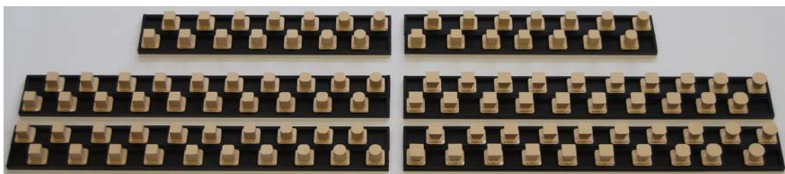
Abb. 7: Rudimentäre Muster mit gestuften tangential- und nicht tangential verlaufenden Kantenverrundungen, zwei Reihen mit R10 Stufung - oben - und 4 Reihen mit R13 Stufung - unten
