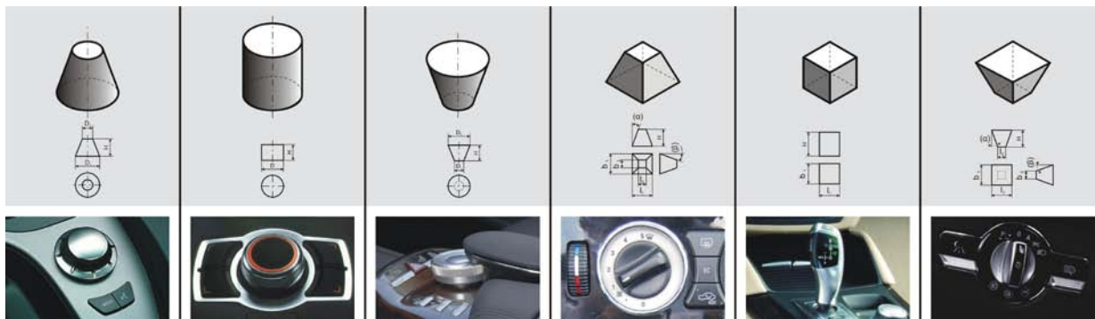
Abb. 2: Abstrakte Darstellung der funktional betrachteten Betätigungsflächen und deren Zuordnung zu realen Stellteilen, nach (Petrov, Maier, 2009a)
