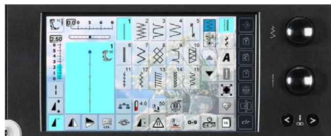
Abb. 1: Getestete Benutzungsoberfläche des BERNINA 830 Näh- und Stickcomputers: Touchscreen und mechanische Bedienelemente.
