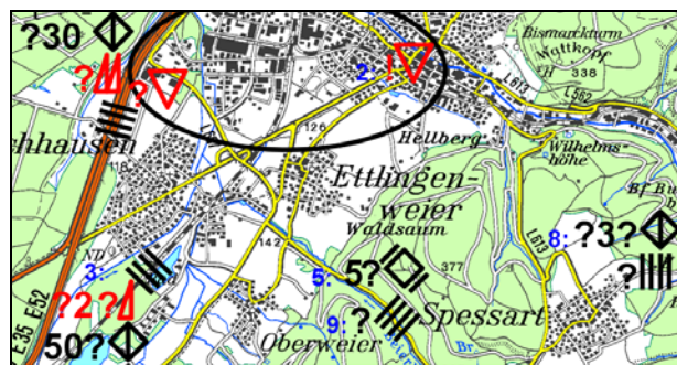
Abb.11: Ausschnitt aus einer Lagekarte mit Darstellung unsicherer Information nach Stand der Technik. Vorangestellte Fragezeichen markieren Schadeninformationen als unsicher.
