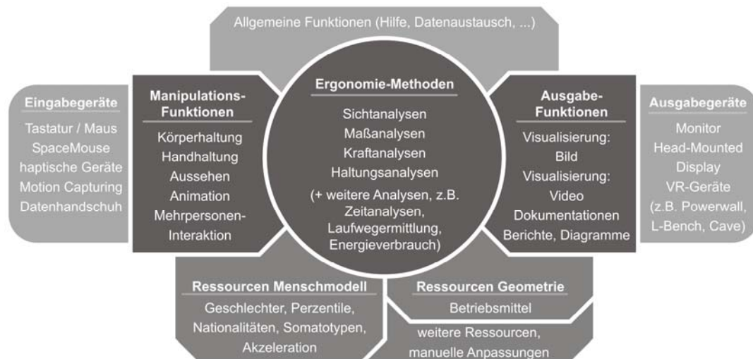
Abb. 3: Funktionsschema digitaler Menschmodelle
